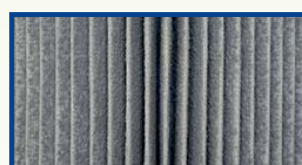
Cartouche filtrante après nettoyage
